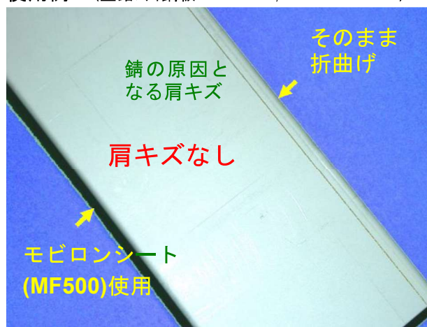
使用例 2 (亜鉛メッキ鋼板 1.2t P/D=88° V=10 mm)
