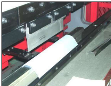
使用例 1 (SUS430 鏡面材 1.2t P/D=88° V=10 mm)
