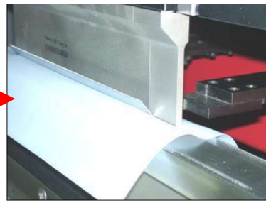
使用例 1 (SUS430 鏡面材 1.2t P/D=88° V=10 mm)
