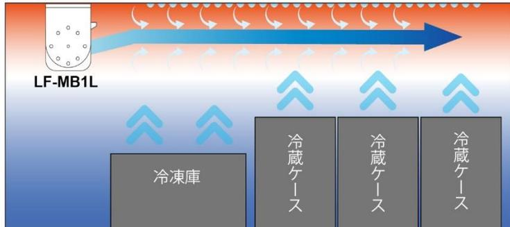
天井結露が発生しているエリアに向けて、クロスフローの整流された平面流を吹き付けます。
